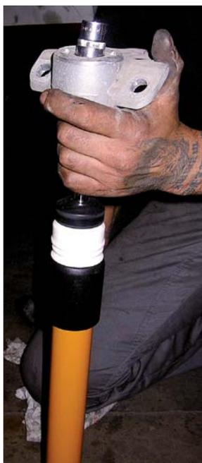
si posizionano i V-Maxx sul pressamolla e si rimonta il piattello superiore. Poi si installano gli ammortizzatori sui fuselli. In seguito si passa agli ammortizzatori posteriori, smontando i supporti di attacco alla
