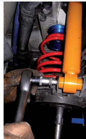
scocca della vettura. Dopo aver smontato il supporto superiore dall'ammortizzatore di serie, si rimonta questo particolare sull'ammortizzatore V-Maxx. Poi si posizionano le molle e i registri a ghiera filettata per
