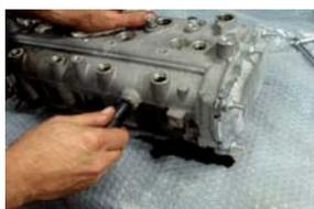
e debitamente protetta nella parte inferiore con della plastica, si procede a sfilare la spina/maschera di messa in
