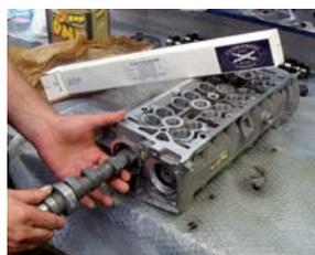
coppia di ingranaggi sempre in presa. Poi si smonta la puleggia dentata di distribuzione e si procede smontando i due alberi a camme. A questo punto si installano gli alberi a camme Colombo & Bariani all'interno della semitesta e le ruote dentate dopo aver rimontato la spina/maschera per la giusta messa in fase. Poi vengono serrate le ruote dentate con la chiave dinamometrica. In
