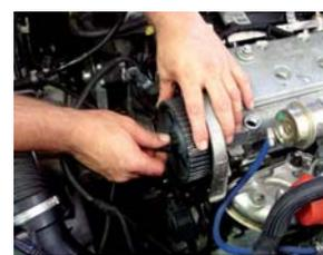
seguito si procede al montaggio della semitesta sul monoblocco impiegando una nuova guarnizione di tenuta. Si prosegue montando la puleggia dentata, dopodiché, con i riferimenti di serie si ripristina la messa in fase e si utilizza una nuova cinghia di distribuzione e un nuovo tendi cinghia. Ovviamente sarà opportuno rivedere la mappatura della centralina sia a livello di tempi di iniezione che anticipo di accensione per adeguare questi due parametri alle mutate capacità respiratorie del motore.
